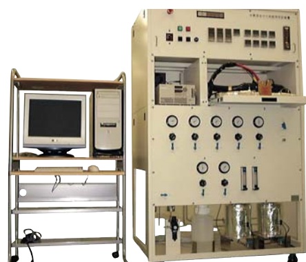
超高圧タイプ：吸蔵圧力測定範囲 0.01 ～ 70MPa
